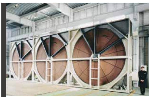
VOC濃縮カセット (VMC-3950V40-N×3連) 風量：160,000m³/hr VOC：IPA、トルエン、etc. 納入先：印刷工場
